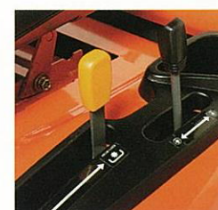
Leva di sollevamento idraulico del piatto
