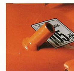
Sistema di attacco della pompa dell'acqua per la pulizia del piatto
