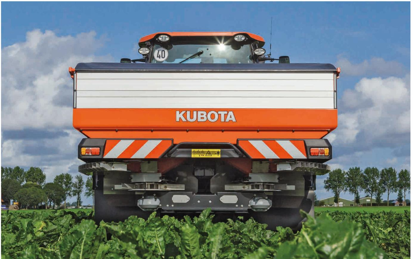
Un deflettore apposito è utilizzato per ottimizzare il passaggio lungo i bordi del campo. Il risultato è la massima copertura fino al limite dell'appezzamento per fertilizzare tutta la superficie coltivata minimizzando le perdite e l'impatto ambientale.
