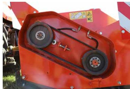
La serie Kubota SE8000 è sempre equipaggiata con la trasmissione laterale doppia. I punti di ingrassaggio sono centralizzati ed esterni per un'agile manutenzione.
