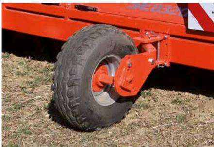
Ruote semi pivotanti (10/8.0 x 12.8) di serie forniscono stabilità e altezza di lavoro costante.
