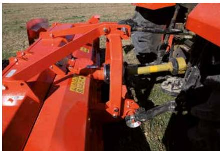
La testata d'attacco semi automatica (CAT III) permette un rapido accoppiamento al trattore. Il perno flottante al terzo punto libera la testata dagli stress del carico di lavoro.
