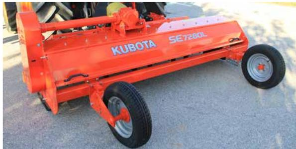
A richiesta, l'SE7280L può avere il rullo posteriore (195 mm) o 2 ruote semi-pivottanti (155 SR13) per il mantenimento dell'altezza di lavoro.
