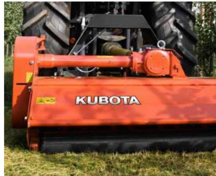
La serie SE1001 è dotata di serie di rullo posteriore che permette di mantenere un'altezza di lavoro precisa.
